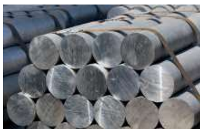
figuur 7 Aluminium wordt beschermd door een dun, maar ondoordringbaar laagje corrosie.
